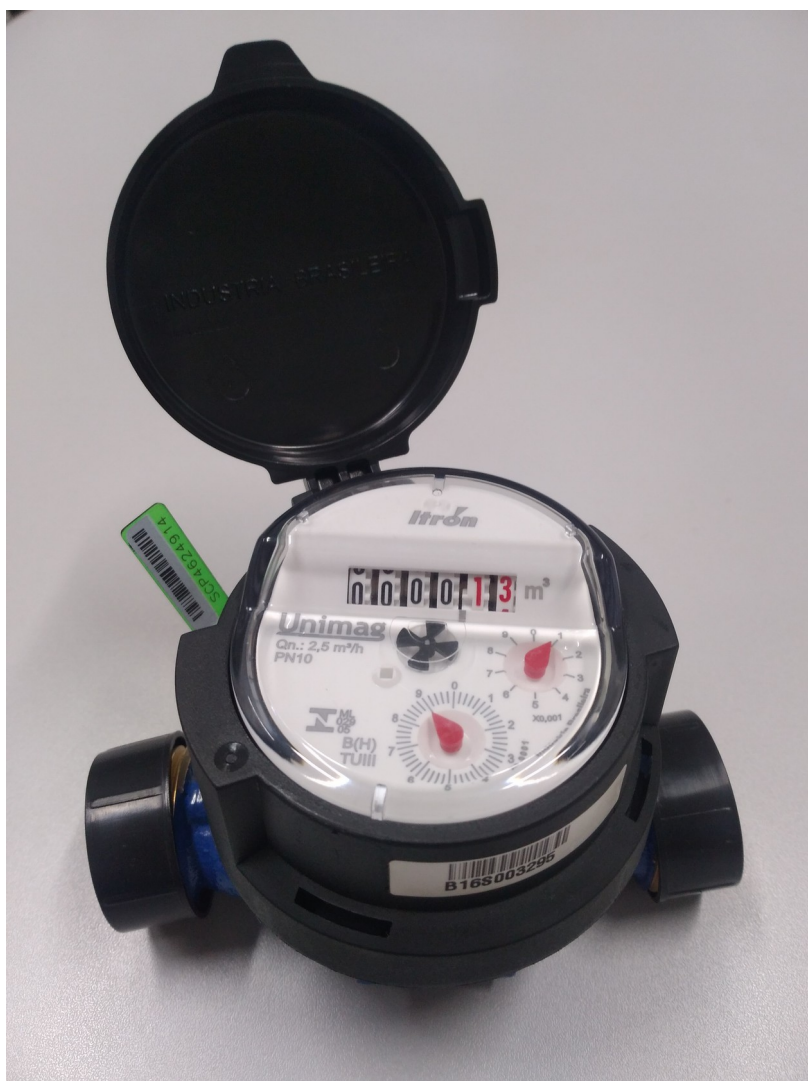
Figura 3 – Exemplo de hidrômetro novo.
